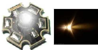
Optischer Eindruck einer kalt-weißen (links) und einer warm-weißen LED (rechts)
