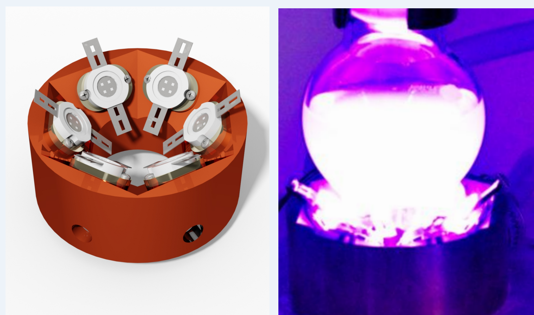
ABBILDUNG 4: CAD Entwurf zur Anordnung typischer 5 W LED Zellen (links); Fertiggestelltes Bauteil bei der Bestrahlung eines 100 mL Laborrundkolbens mit TiO 2 Suspension (rechts).
