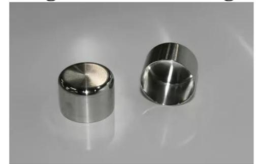
Iridiumtiegel ( $T_m = 2465\text{ }^\circ\text{C}$ )
