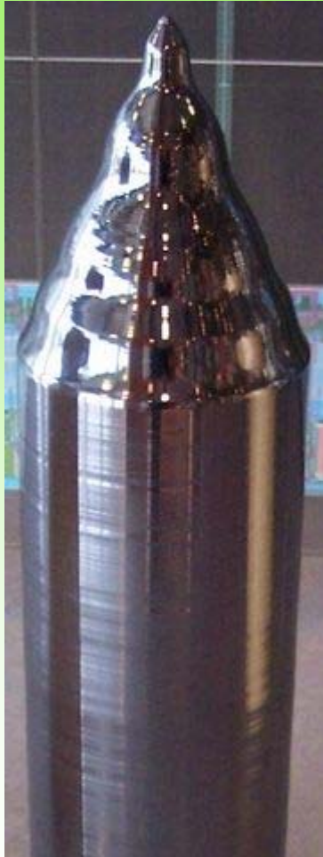
Si-Einkristall zur Waferherstellung
