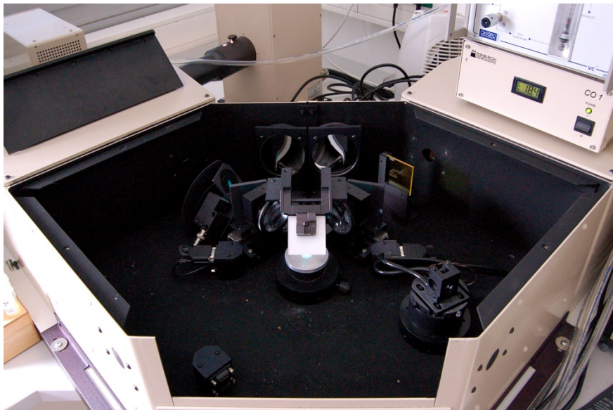
2: Spiegeloptik für pulverförmige Proben
