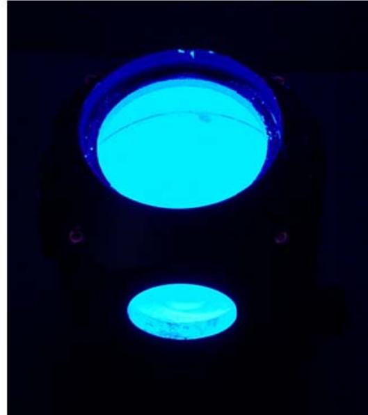
2: Mit BAM beschichtete Ulbricht Kugel
