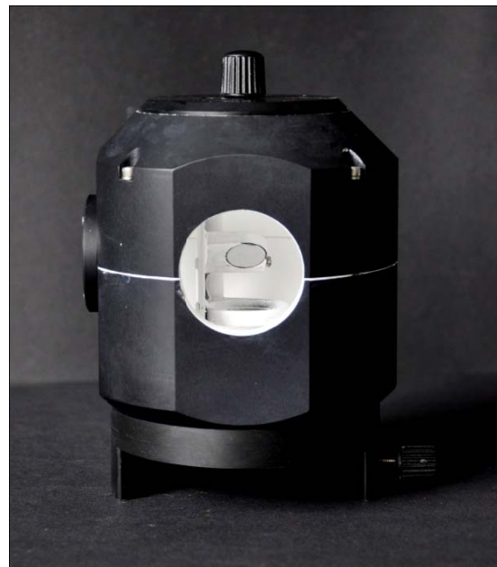
3: Mit LAP-Ce beschichtete Ulbrichtkugel
