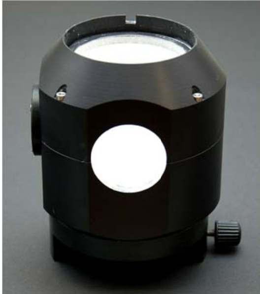
2: Mit BAM beschichtete Ulbricht Kugel
