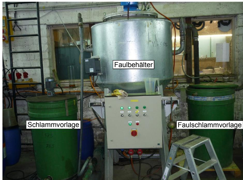
Abbildung 3: Versuchsfaulanlage
