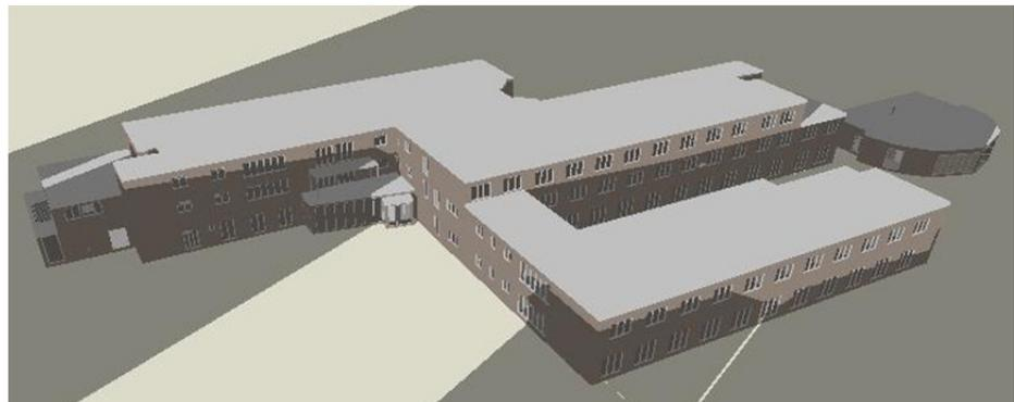
Die thermodynamische Gebäudesimulation erfolgte mit dem Simulationsprogramm DesignBuilder. Mit diesem Programm wurde überprüft, ob der sommerliche Wärmeschutz im Altenpflegezentrum St. Josef in Sassenberg eingehalten werden kann. Zudem wurde untersucht, welche maximalen Innenraumtemperaturen sich in den Räumen einstellen und anhand von Variantenrechnungen gezeigt, welche Möglichkeiten bestehen, die sommerlichen Höchsttemperaturen zu stabilisieren bzw. den thermischen Komfort zu verbessern.
