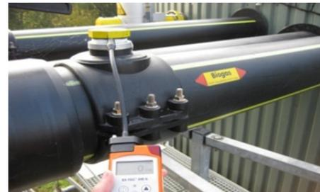
Abb. 1: Erfassung des Eigenstromverbrauchs (links) und Aufspüren von Methanleckagen (rechts)
