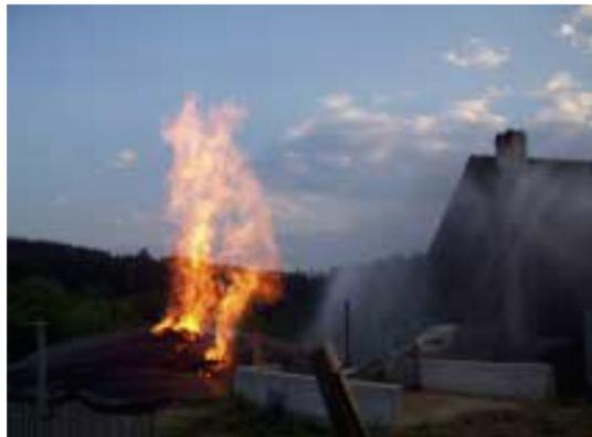
Abbildung 3: Brennender Gassack, das Gas verbrennt am Leck
