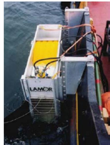
Die linke Abbildung zeigt einen Wehr- oder Überlaufskimmer [2], die rechte einen Bürstenskimmer eines Kollektor Systems [3].
