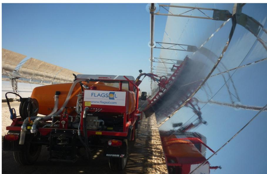
Abb. 3: Spiegelreinigungsanlage während der Reinigung
