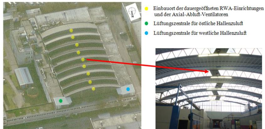
Abb. 2: Gebäudeansicht Nord – Lage der RWA-Öffnungen u. Axialventilatoren
