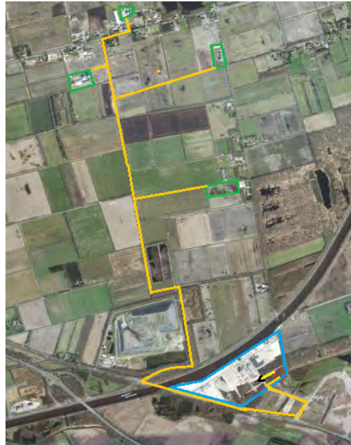
Abbildung 1: Lageplan Biogasanlagen (grün) und Industriegebiet (blau) mit Biogasaufbereitungsanlage (rot), Verlauf der Sammelleitung (gelb) und Einspeisepunkt (schwarz)
