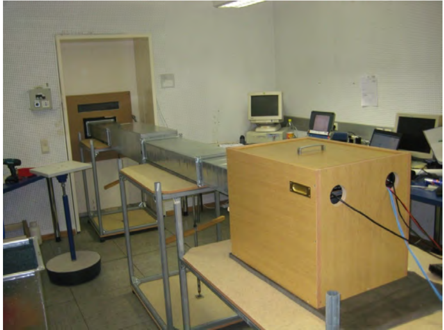
Abbildung: aufgebauter Prüfstand mit Schalldämpfer
