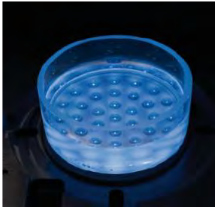
Abbildung 12: Desinfektionsmodul zur Erforschung von UV-LEDs (Quelle: TU Berlin)
