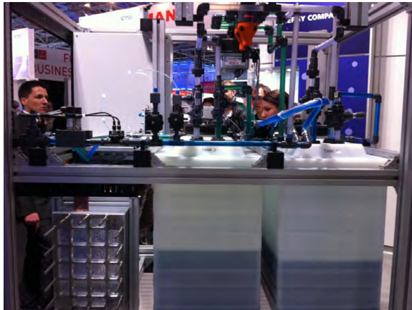
Prototyp einer Redox-Flow-Batterie des Fraunhofer Instituts
