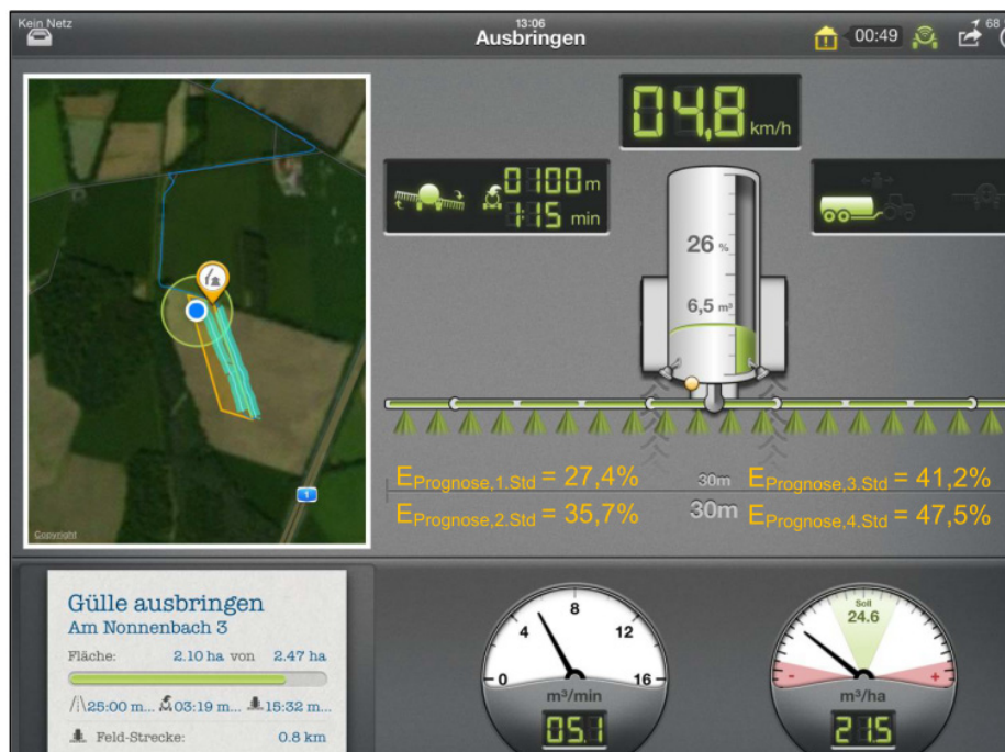
Abb. 1: Darstellung der Applikation „garant SmartControl for iPad“ mit der möglichen Integration einer Prognose des relativen Ammoniakverlustes in (%)
