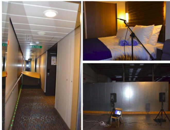
Verwendeter Aufbau zur Vermessung der Kabine
