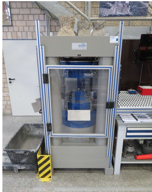
Durchführung von Prüfungen zur Ermittlung der Druckfestigkeiten von Leicht-, Mittel- und Schwerbeton bis 5000 kN
