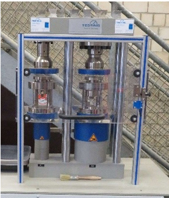
Durchführung von Prüfungen zur Ermittlung der Druckfestigkeiten bis 300 kN und Biegezugfestigkeit bis zu 15 kN an Zement-, Mörtel- und Gipsproben, sowie Leicht- und Porenbeton
