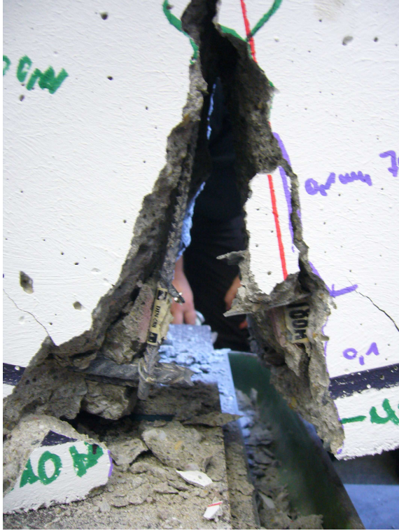
Schwach bewehrter Stahlbetonbalken: Versagen in der Zugzone
