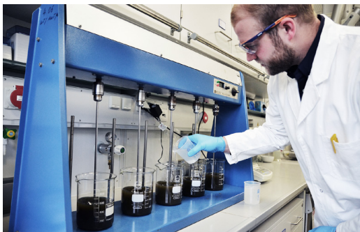
κ Lukas Wettwer fügt das Flockungsmittel den Gülleproben zu.
