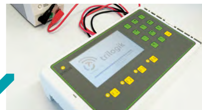
Ein universelles Bediengerät, hier für eine Steuerung zur punktgenauen Aussaat in der Landwirtschaft, entwickelt von der Firma trilogik.
